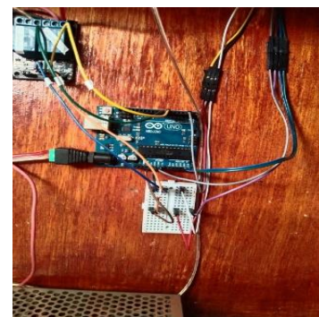
Gambar 8. Pemasangan Mikrokontroler Arduino
