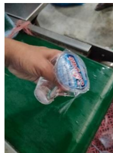
Gambar 2. Cacat Kemasan Bocor
