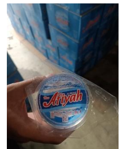
Gambar 3. Cacat Lid Miring dan Tidak Terpotong
