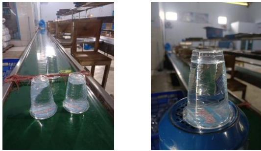
Gambar 4. Cacat Produk Tidak Terisi Penuh
