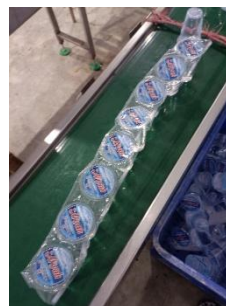
Gambar 3. Cacat Lid Miring dan Tidak Terpotong
