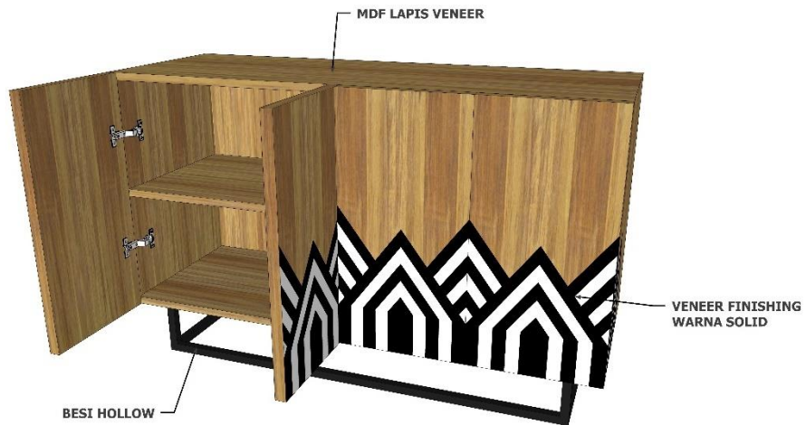
Gambar 10. Detail Material Sumber: Dokumentasi Penulis, 2025
