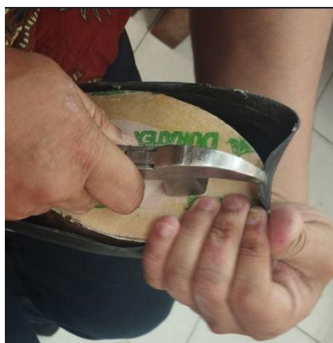
Gambar. 2 Penarikan Bagian Toe Upper Sumber: Dokumentasi Penulis
