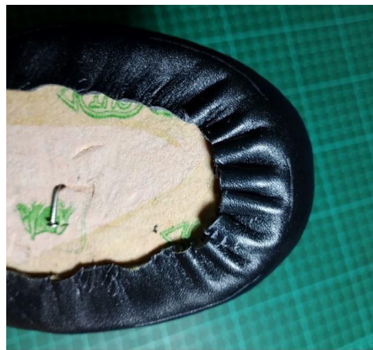
Gambar. 4 Hasil Lasting dengan toe puff 1,5 mm Sumber: Dokumentasi Penulis
