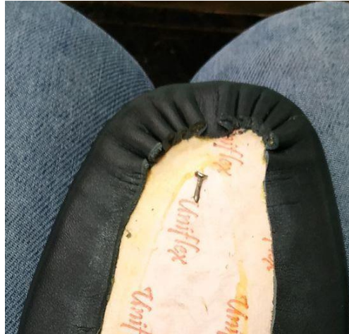
Gambar 1. Wrinkle Area Lasting Sumber: Dokumentasi Penulis
