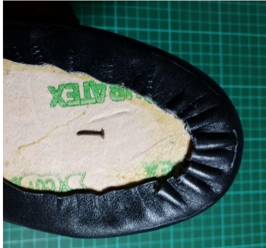
Gambar. 3 Hasil Lasting dengan toe puff 1,0 mm Sumber: Dokumentasi Penulis
