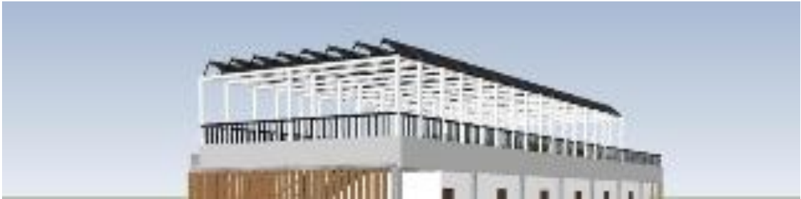
Gambar 4: Perletakan solar panel pada area rooftop bangunan
