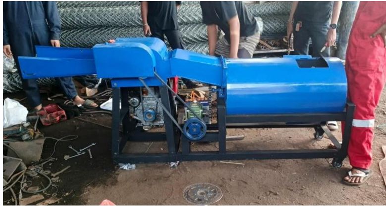
Gambar 4. Proses Pengujian Mesin Pencacah Rumput dan Pengaduk Pakan Ternak
