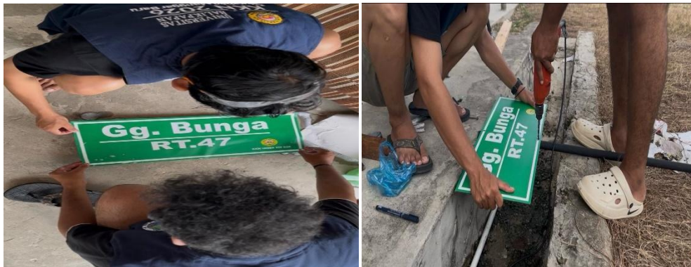
Gambar 4. Proses Penggabungan Plakat ACP dengan Tiang Galvanis Melalui Metode Pengeboran
